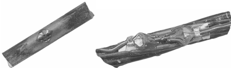
Slika 10. - Postavljanje rozete za određivanje stanja postojećeg stanja napona u armaturi i kablovima za prednaprezanje [7]
