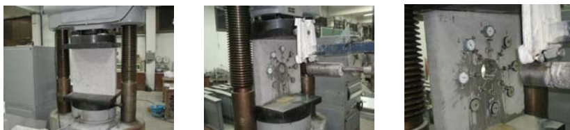
Slika 3. Postupak određivanja koeficijenata baždarenja u laboratoriskim uslovima [4]
