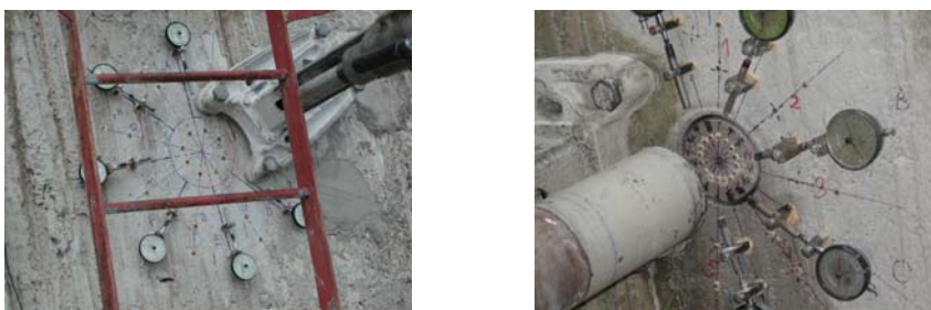
Slika 2. Upotreba dilatometara i mjernih satovi (ugibomjera) kod utvrđivanja postojećeg stanja napona na AB konstrukciji [4]
